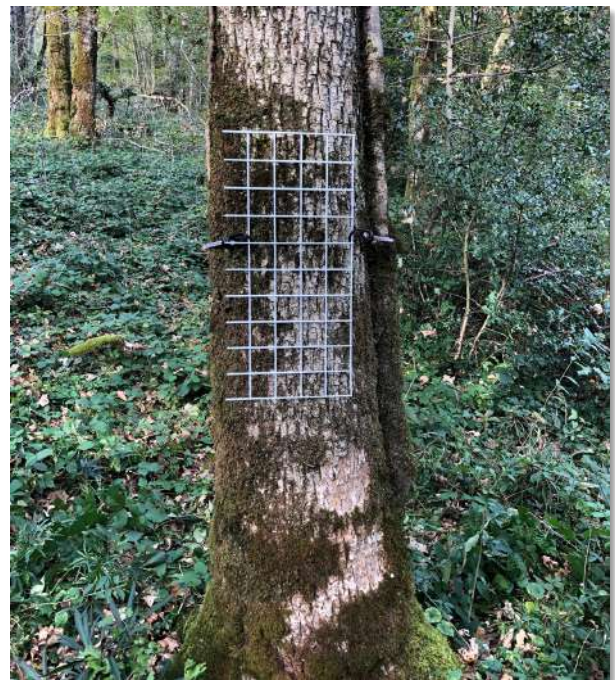
Figure n°3 - dispositif adapté pour le suivi diachronique des micro-communautés bryo-lichéniques sur les bois de diamètre réduit. Test dans un îlot de vieillissement en forêt de Chailluz sur un érable sycomore de 35 cm de diamètre (G. Bailly).
